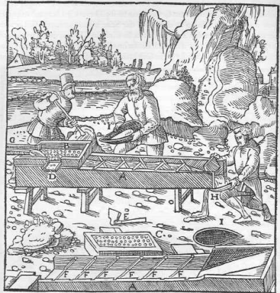
Das Gerinne A. Der Trog B. Sein umgekehrter Boden C. Sein stütlicher Auslaß D. Eine eiserne Krücke E. Die Bretchen F. Das Wässgerinne G. Der Sicheretrog, in dem das, was sich abgesetzt hat, aufzufangen wird H. Ein Sicheretrog, in dem es verwaschen wird I.
